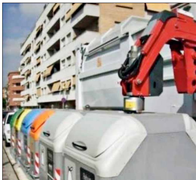
Figura 11. Detalle del sistema de captura de contenedor tipo seta
